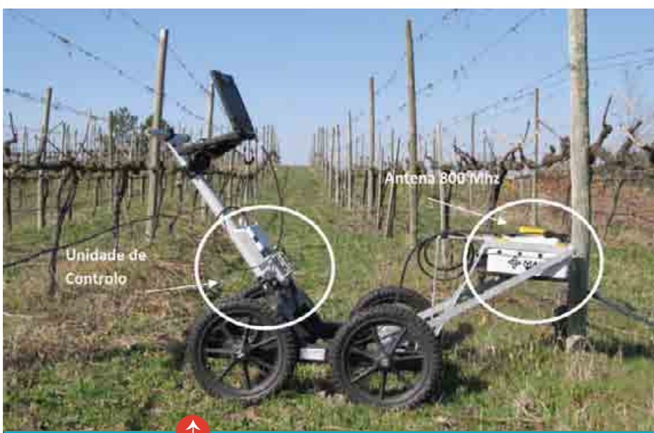
Figura 4 Equipamento usado no trabalho de campo com a antena acoplada a cerca 40 cm do solo
